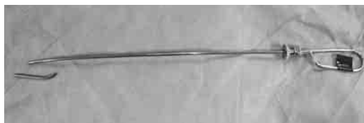
写真3 折れたスタイレット（全体） 先端から5-6cmの部位で折れている
